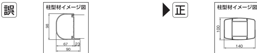
本体P.99ファサードサイン構造図〈アドフレックス〉ウォールタイプ180LED-II寸法訂正。
