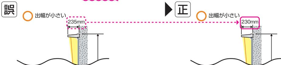
本体P.119掲示板(アルミ縦スライド型)HK自立タイプ柱型材イメージ図の訂正。
